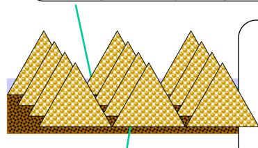
Die mikroreplizierten Pyramiden sind so genau positioniert, das eine definierte Schleifmittelstruktur entsteht.
